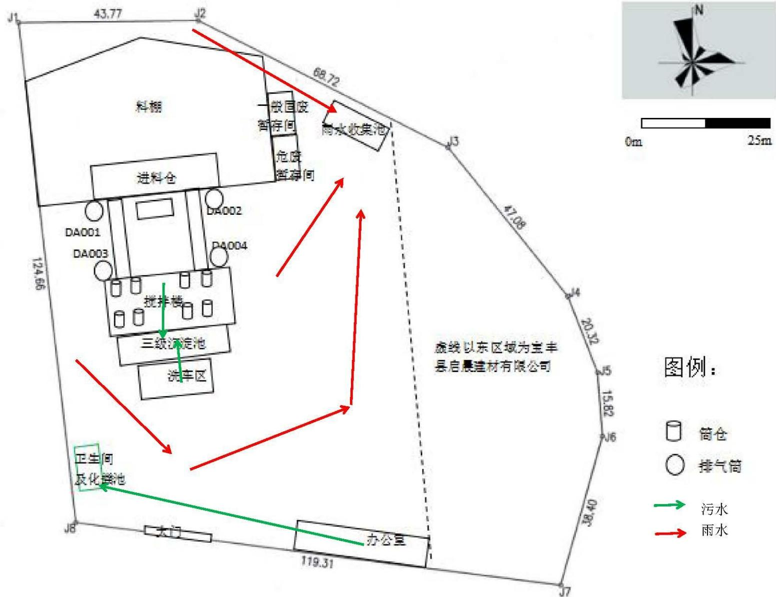
附图五 项目雨污分流及流向图
