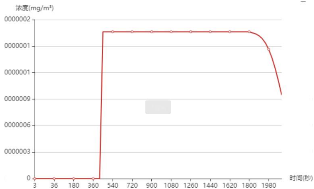
图 1-5 硫酸储罐泄漏最不利气象条件下最近敏感点（石洼村）浓度随时间变化情况
